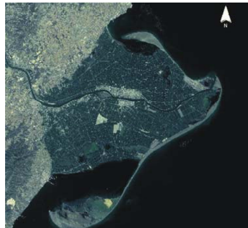
Fig.2.10.: Imagen en falso color del Delta del Ebro obtenida por combinación de escenas SPOT-PAN y Landsat V-TM obtenidas en 1995.
