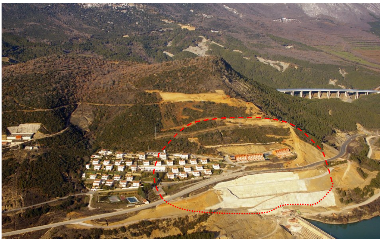
Figura 4.1.1: Vista aérea de la ladera derecha de la cerrada del embalse de Yesa en la que se muestra el alcance aproximado de la masa inestable estudiada. Se observan las actuaciones que se están llevando a cabo para su estabilización, cuando estas se encontraban en sus fases iniciales: eliminación de peso en coronación y aplicación de una masa estabilizadora al pie (Foto tomada de www.yesano.com , autor Miguel Santamaría).
